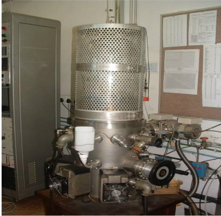
Figure III-1: Image de l'évaporateur thermique à canon-à-électrons d'iThemba LABS (Afrique du Sud) utilisé pour le dépôt de nos échantillons cibles.
